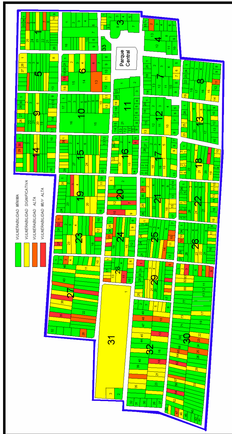
Figura 18. Mapa del sector estudiado que ilustra el grado de vulnerabilidad estructural de cada lote evaluado, ante fenómenos sísmicos que presenten aceleraciones del suelo iguales o mayores a 0.3g en la componente horizontal.
