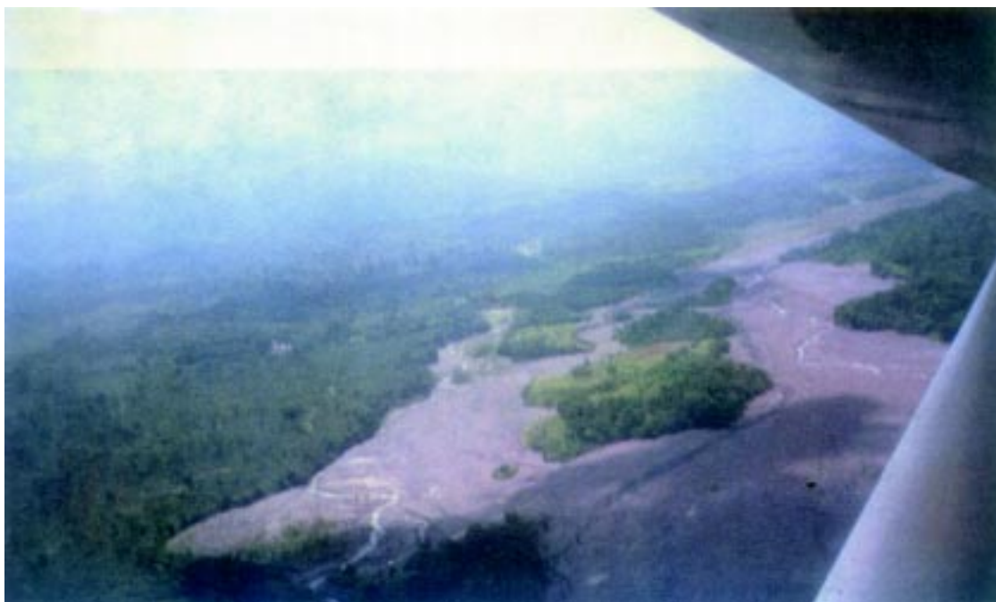
Vista aérea del azolvamiento del río Nima II (lado derecho) al río El Tambor (lado izquierdo). Cambios geofísicos severos secundarios al lahares, procedentes del volcán Santiaguito observados en 1990, cuando el río El Tambor cambió de cauce. Aguas abajo, ambos caudales desembocan en el río Samalá con todo el material volcánico
