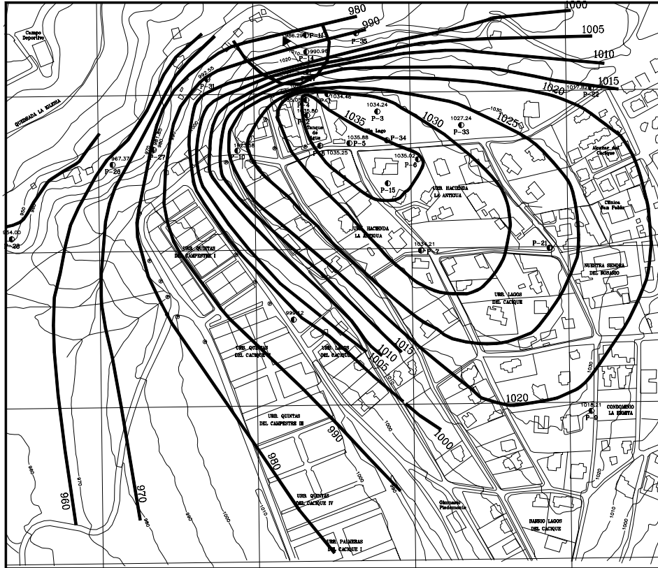
Figura 10.9 Líneas de nivel freático inducidas por la infiltración de un tanque de almacenamiento de agua que produjo el deslizamiento de la Colina en Bucaramanga – Colombia-1996.
