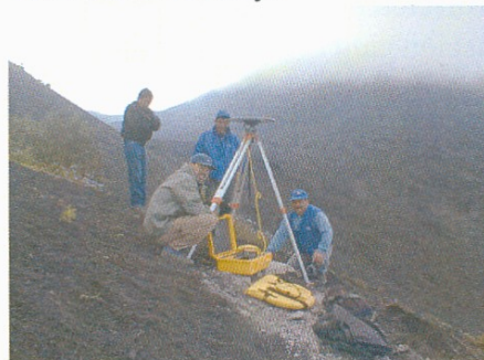
Medición de las líneas base con GPS del volcán de Pacaya
