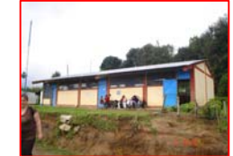
FOTOGRAFIA 2 Estructura portante de cubierta en buen estado, se deben reemplazar algunas láminas que están deterioradas. Muros, ventanas y puertas en buen estado.
