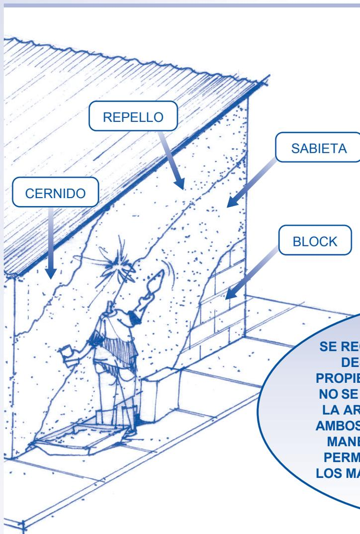
Para evitar que los muros se humedezcan es necesario aplicar sobre el block, una capa de sabieta y luego una capa de repello. Si sus posibilidades se lo permiten puede aplicar un cernido como acabado final aunque no es necesario.
